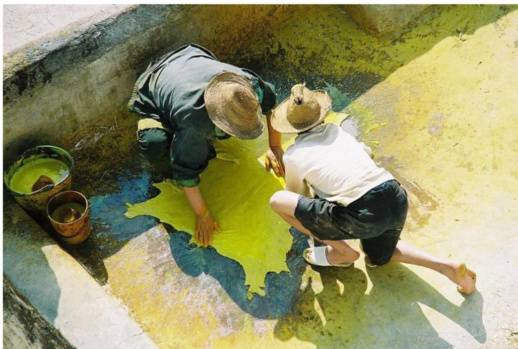
Fig. 6. Teñido de pieles en color amarillo mediante frotación (Tenerías Chouara de Fez).
